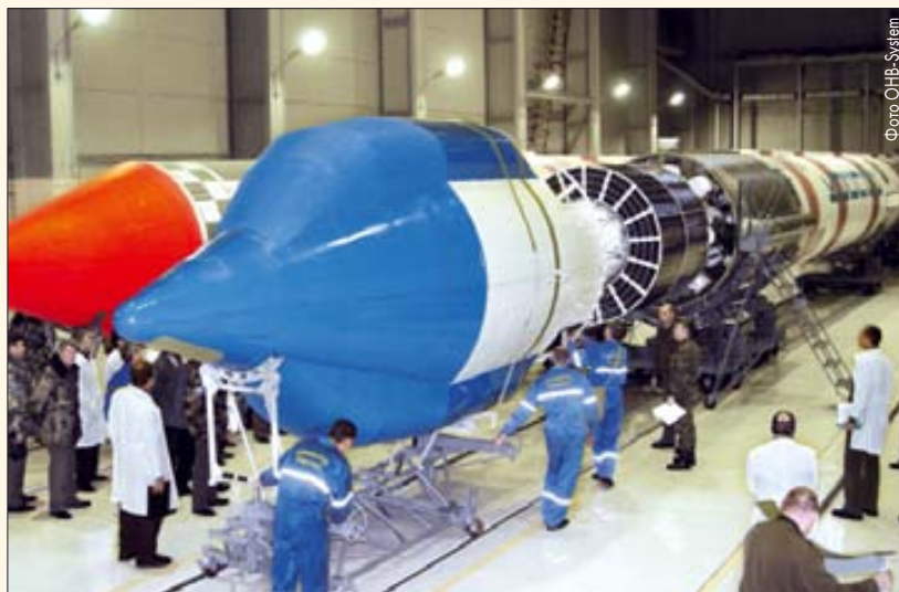
Накатка нового обтекателя РН «Космос-3М». Хорошо видна основная полезная нагрузка – КА «Парус»
