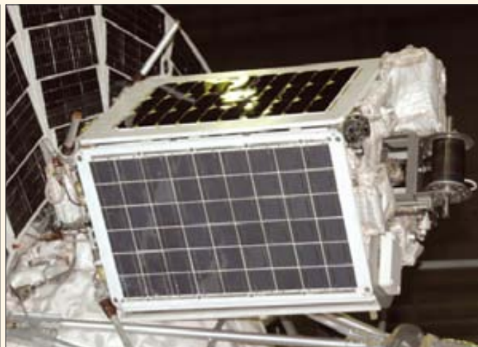
Микроспутник «Татьяна», установленный на КА «Парус»
