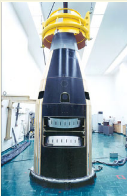
КА KH-4B на заключительной сборке на фирме Lockheed. Видны корпуса двух панорамных камер и крышка картографической камеры
