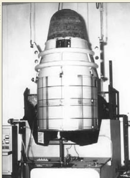
КА MURAL (KH-4) на вибрационных испытаниях
