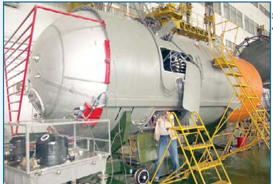
Установка блоков системы управления на третью ступень РН «Союз-ФГ»
