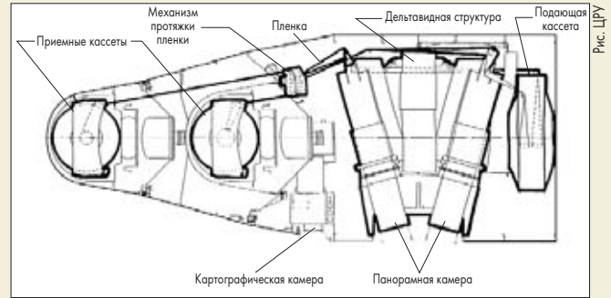
Конструкция фоторазведчика KH-4B
