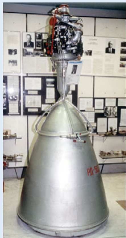
Экспериментальный двигатель РД-502 на компонентах «перекиси водорода – пентаборан»
