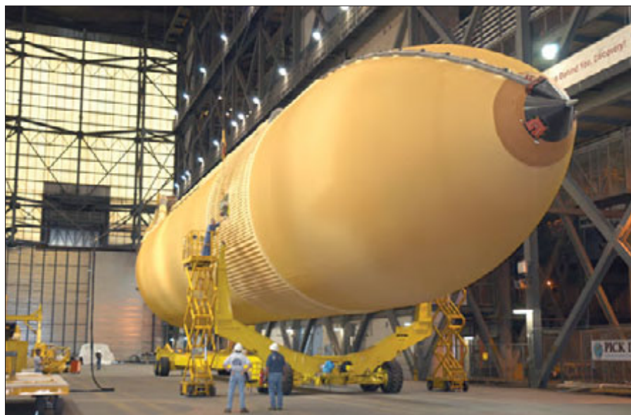
Внешний бак ET-118 перед отправкой на завод-изготовитель в г.Мичиган для устранения дефектов конструкции, вызвавших гибель «Колумбии»
