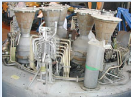
Единственный перекисной двигатель, который «увидел космос» – Gamma 8 для первой ступени РН Black Arrow
