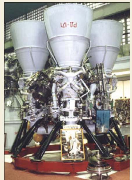
Двигатель 1-й ступени РН «Зенит» – РД-171
