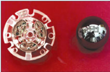
Гироскопы GP-B – сердце эксперимента
