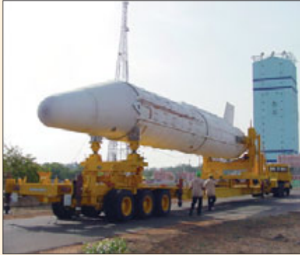
Транспортировка навесных жидкостных ускорителей к передвижной башне обслуживания
