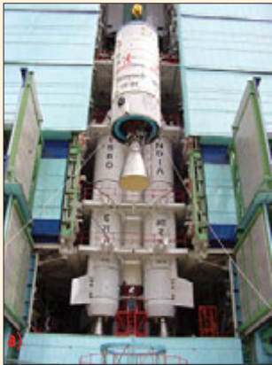
а) Жидкостная 2-я ступень поднимается для установки на 1-ю ступень; б) Криогенная ступень опускается для установки в верхней части 2-й ступени; в) КА Edusat, заключенный в головном обтекателе, устанавливается на верхней части отсека оборудования РН
