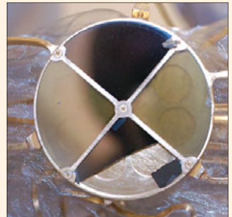
Ионный концентратор. Четвертый сегмент поврежден
