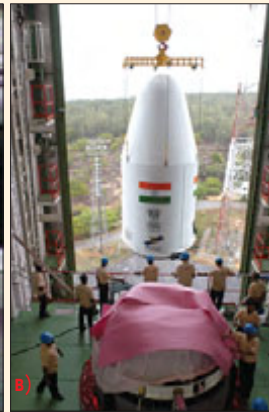
а) Жидкостная 2-я ступень поднимается для установки на 1-ю ступень; б) Криогенная ступень опускается для установки в верхней части 2-й ступени; в) КА Edusat, заключенный в головном обтекателе, устанавливается на верхней части отсека оборудования РН
