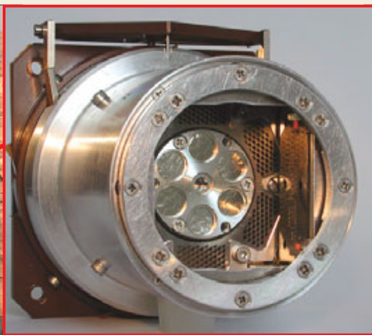
Общий вид и размещение на манипуляторе марсоходов MER альфа-протон-рентгеновского спектрометра APXS. Справа – принципиальная схема APXS
