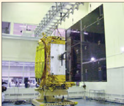
Тест на раскрытие панелей солнечных батарей спутника Edusat
