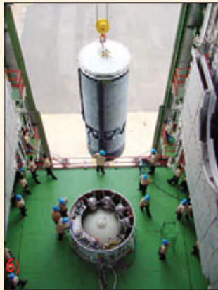
а) Жидкостная 2-я ступень поднимается для установки на 1-ю ступень; б) Криогенная ступень опускается для установки в верхней части 2-й ступени; в) КА Edusat, заключенный в головном обтекателе, устанавливается на верхней части отсека оборудования РН
