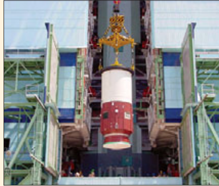
Монтируются основной кожух и первый сегмент основной твердотопливной ступени
