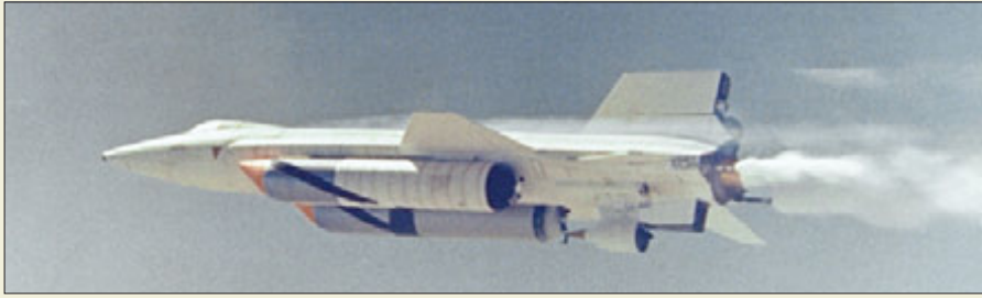
X-15A-2, пилотируемый Питом Найтом, нес модель СПВРД
