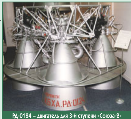
RD-0124 – двигатель для 3-й ступени «Союза-2»
