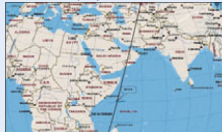
Трасса полета при выведении солнечно-синхронную орбиту i=99.4^\circ , H=1000 км
