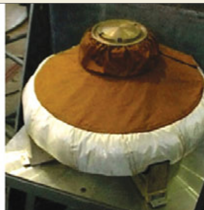
Малая метеорологическая станция российско-финляндского проекта MetNet с наполненным основным надувным устройством перед входом в атмосферу
