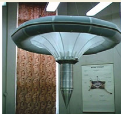
Станция с раскрытым дополнительным надувным устройством перед посадкой на поверхность
