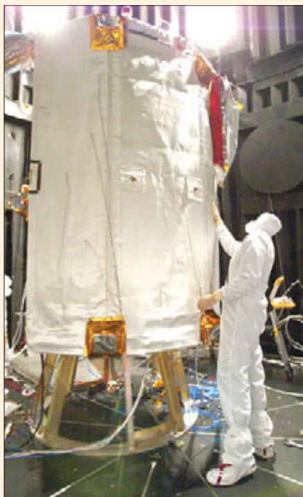
Установка солнцезащитного экрана
