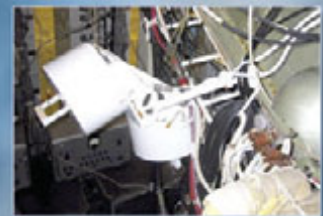
Антенны WAS 1,2 с надетыми крышками
