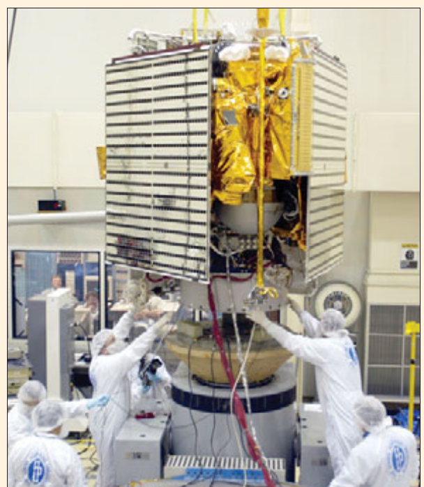
AMC Messenger на вибростенде
