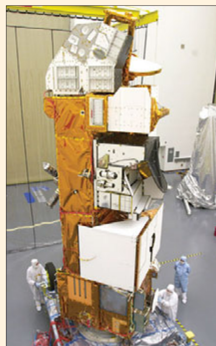
КА Aura на акустических испытаниях
