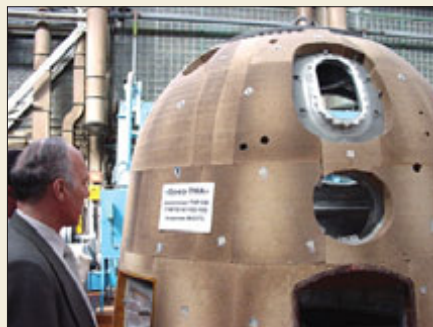
Корпус спускаемого аппарата «Союза ТМА-7» (№217) уже изготовлен
