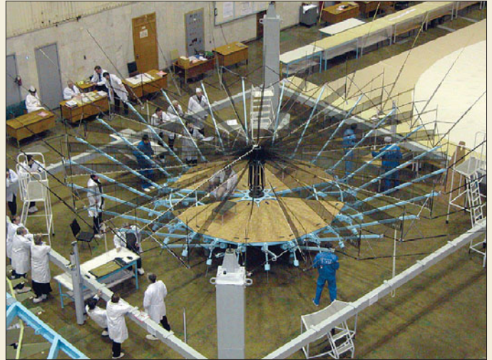
Каркас антенны диаметром 12 м (в закрытом и открытом виде) в сборочном цехе РКК «Энергия»
