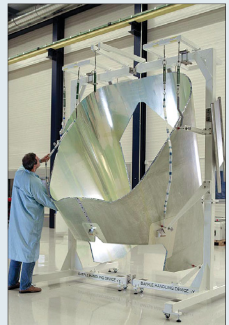
Технологический экземпляр бленды в цехе компании Contraves Space AG. Февраль 2004 г.
