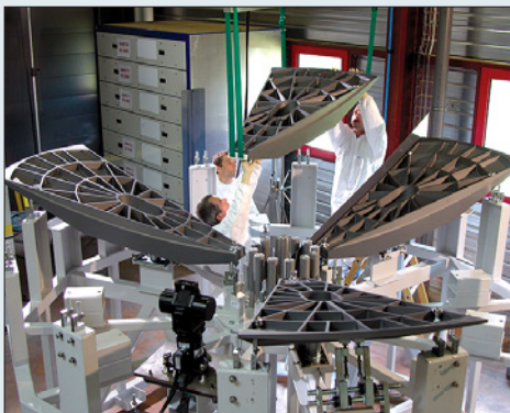
Монтаж главного зеркала телескопа Herschel
