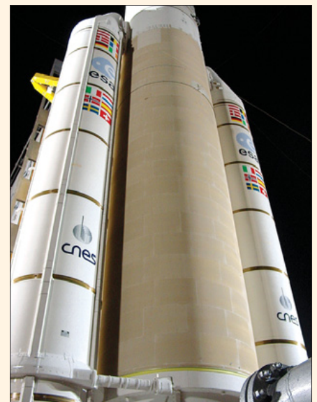
Теплоизолирующая пена покрывает водородный бак РН
