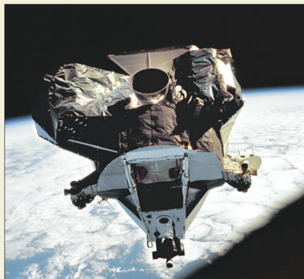
Взлетная ступень LM идет на стыковку с CSM
