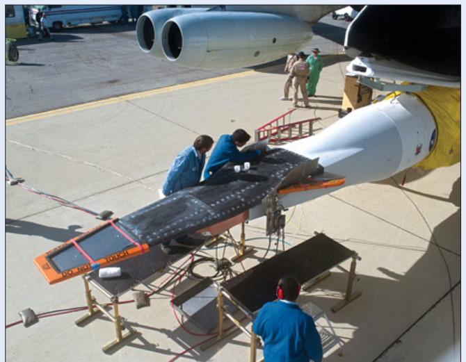
Последние проверки X-43A перед полетом. (Обратите внимание на красные заглушки, защищающие нос и передние кромок)
