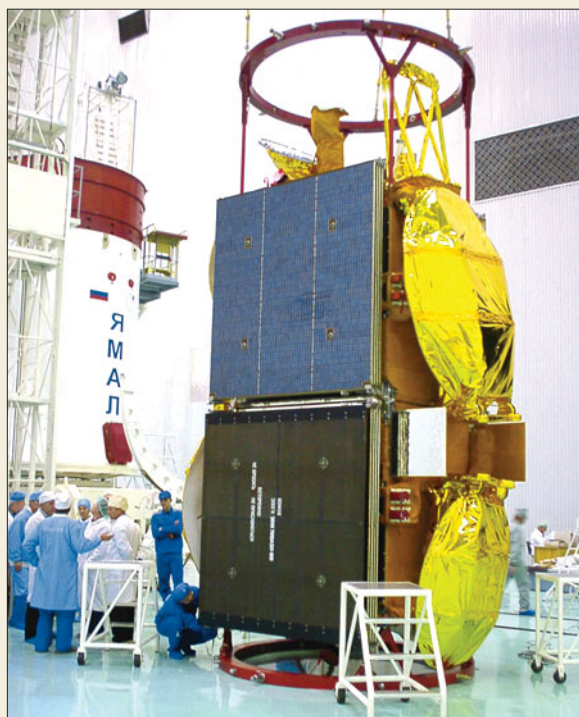
Блок из двух аппаратов «Ямал-200» на окончательном этапе сборки. Масса каждого аппарата — 1350 кг
