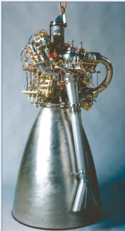
Двигатель HM-7 для третьей ступени РН Ariane 1...4
