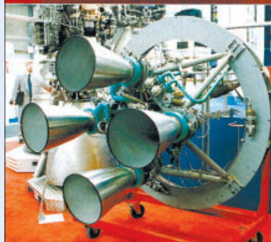
Первые испытанные на стенде французские кислородно-водородные двигатели НМ-4
