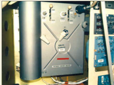
Блок раздачи и подогрева питьевой воды системы регенерации воды из конденсата атмосферной влаги СРВ-К2М
