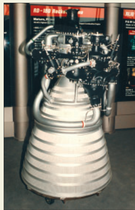
Первый в мире кислородно-водородный двигатель RL-10. В заголовке статьи – первый запуск PH Atlas Centaur 8 мая 1962 г.
