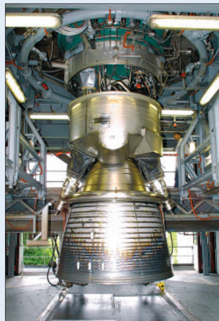
Vulcain 2, подготовленный к стендовым испытаниям
