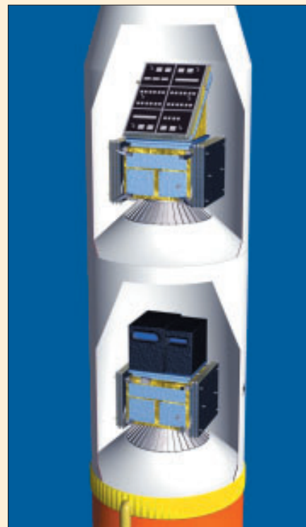
Размещение спутников под головным обтекателем: сверху – радиолокационный IGS-R2, внизу – оптический IGS-O2
