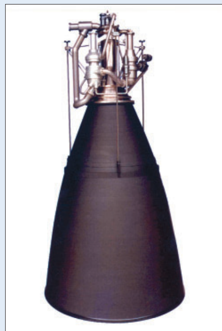
Перспективный двигатель Vinci для верхней ступени Ariane 5/ESC-B
