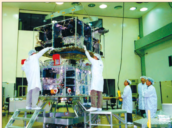
Сборка спутниковой платформы. Соединение приборного отсека с отсеком ПН
