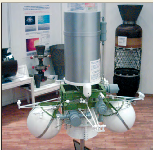
Модель (1:2) многофункционального двигателя на основе СЭДУ, разрабатываемого совместно с НПО «Энергомаш». На заднем плане – демонстрационный гибридный двигатель
