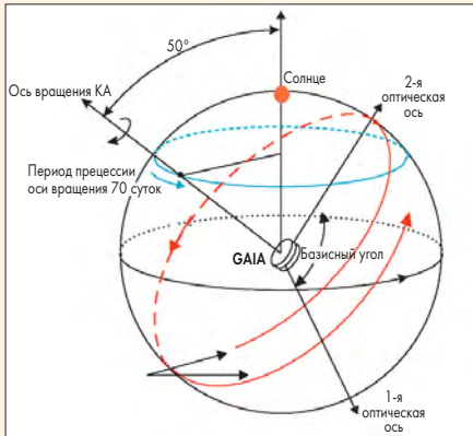
Схема астрометрических измерений с КА GAIA
