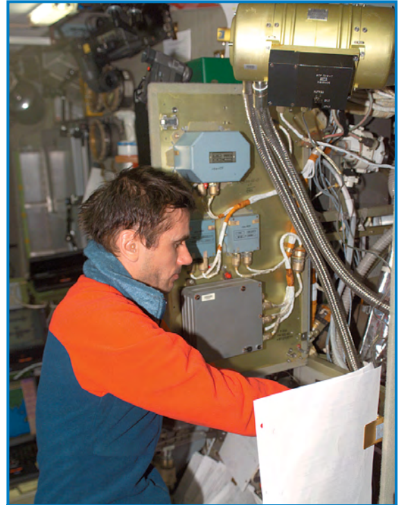
Юрий меняет выработавший свой ресурс (450 литров) блок фильтрации и очистки в системе получения воды из конденсата (СРВ-К2М)
