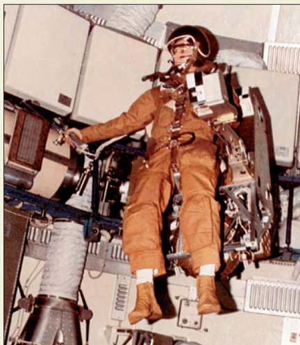
Испытания ранцевой и ручной установок перемещения
