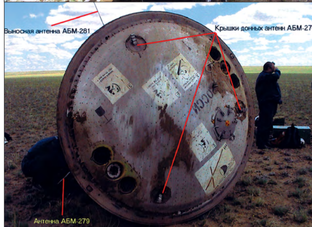
Расположение антенн на спускаемом аппарате «Союза ТМА-1»
