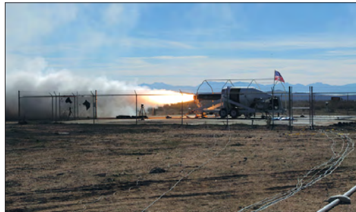
Испытание ГРД фирмы SpaceDev, работающего на твердом полибутиadiене с конечными гидроксильными группами НТРВ (hydroxyl terminated polybutadiene, горючее) и жидкой закиси азота ( N_2O , окислитель), известной также как «веселящий газ». Корпус двигателя и бак окислителя изготовлены Scaled Composites; две компании конкурируют в деле создания заряда твердого горючего, инжектора окислителя и системы трубопроводов. Оба варианта ГРД прошли стендовые испытания
