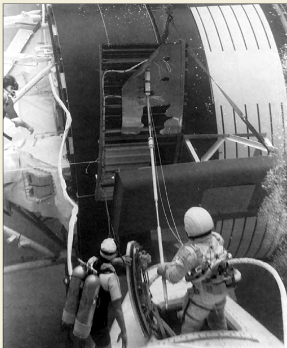
Тренировки в гидробассейне по раскрытию панели СБ
