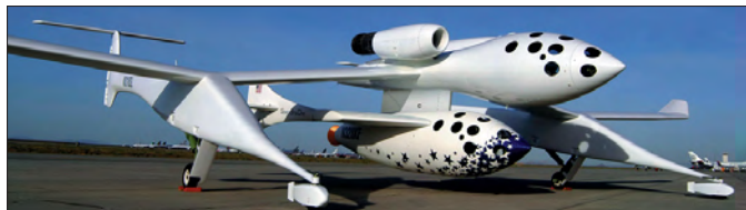
Пассажирский аппарат SpaceShipOne подвешен под самолетом-носителем White Knight
