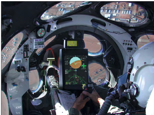
Кабина пассажирского аппарата SpaceShipOne (вид из кабины самолета-носителя практически аналогичен)
