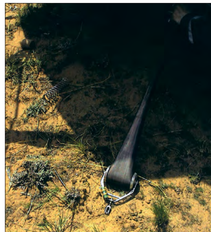
Не полностью раскрывшаяся УКВ-антенна АБМ-279
