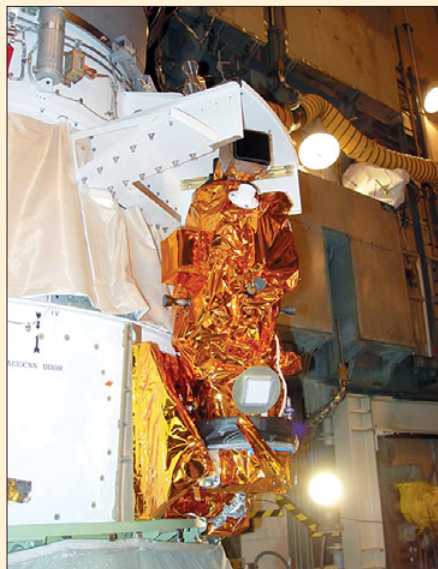
КА XSS-10 закреплен на 3-й ступени PH Delta
