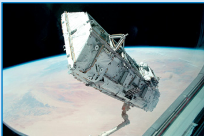
Перенос фермы S0 станционным манипулятором
