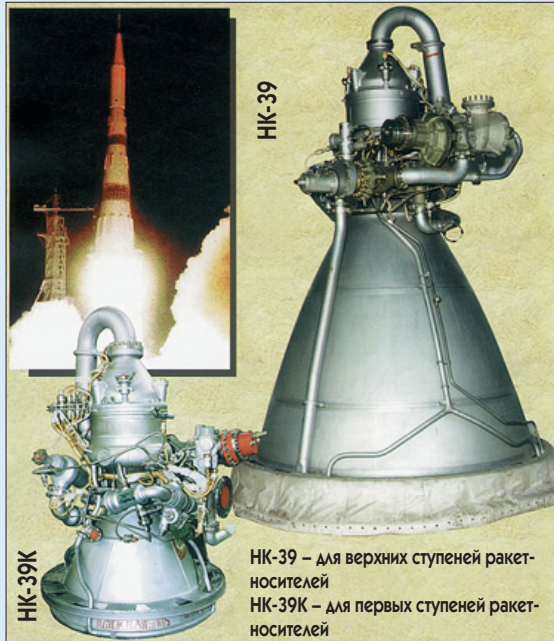
Исходный двигатель НК-39 и его «земной собрат» НК-39К с укороченным соплом. Этим двигателем очень интересовались американские ракетчики, работающие над проектом легкого носителя RASCAL
