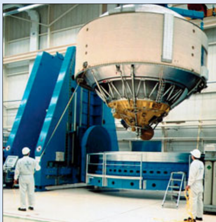
Внешний вид новой криогенной ступени ESC-A
