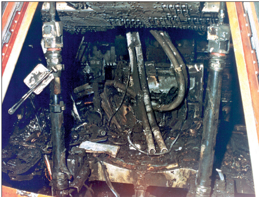
Вид кабины через люк после пожара
