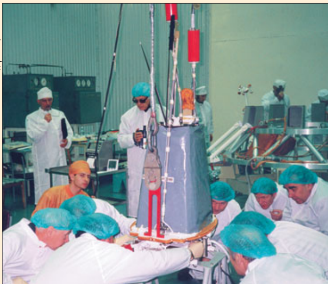
Установка МКА «Компасс» на автономную платформу отделения
