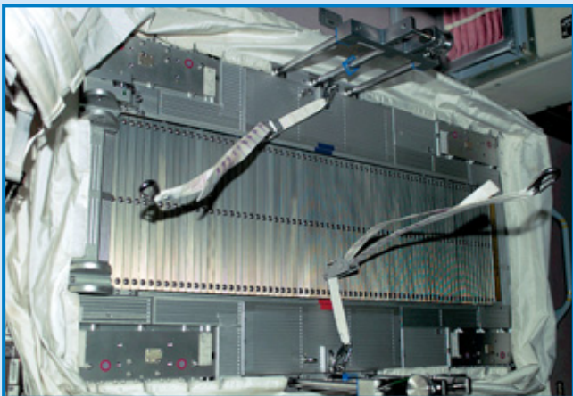
Система виброизоляции бегущей дорожки TVIS
