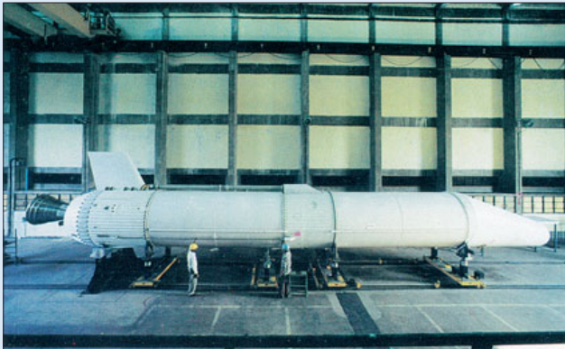
Жидкостный стартовый ускоритель для GSLV, на котором будет установлен форсированный вариант двигателя Vikas
