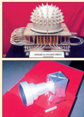
Полусферическая антенна ФАР для передачи информации на малогабаритные приемные станции (вверху); звездный датчик системы ориентации
