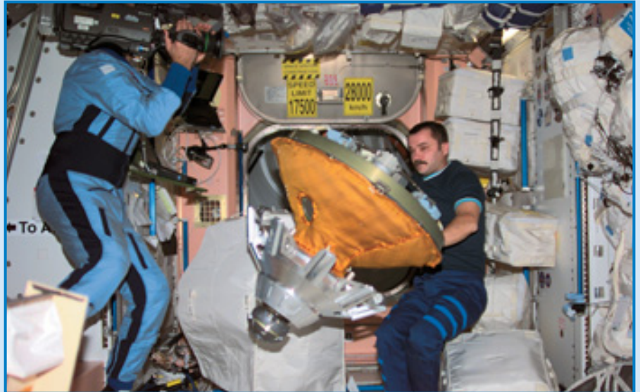
Перенос стыковочного конуса для приема СО «Пирс»
