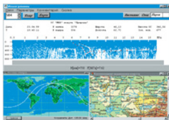
На рисунке показан пульт оператора-космонавта. Такой же пульт имеет оператор, работающий на приемной станции на Земле. В верхней части показана стандартная ионограмма, непосредственно с которой работают операторы. Красными и черными точками подсвечены т. н. «действующие глубины» расположения плазменных слоев в зависимости от частоты зондирования. Внизу слева показана траектория движения ОК «Мир», красная точка – расположение станции в момент съемки. Внизу справа – точное положение подспутниковой точки.
