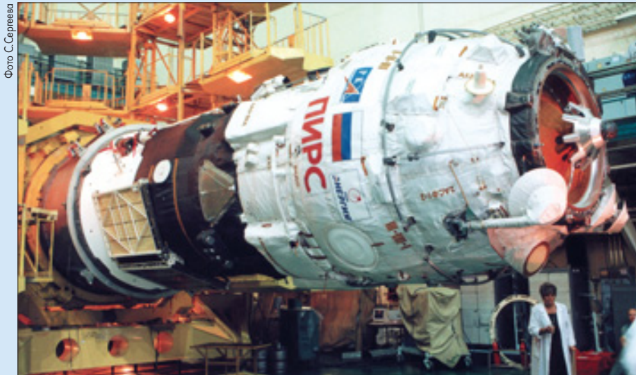
Стыковочный отсек перед накаткой обтекателя
