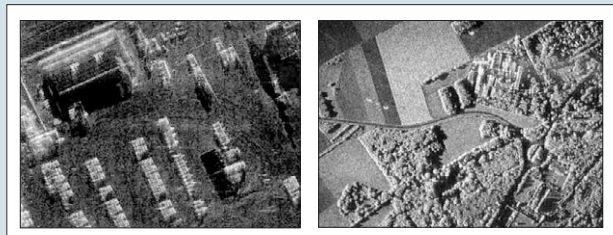
Радиолокационные изображения местности и военной базы (разрешение 0.3–1 м), полученные с помощью американского беспилотного ЛА. Аналогичные снимки будут формировать КА системы SAR-Lupe
