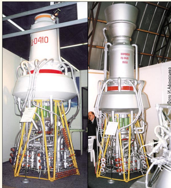
Первый (и единственный) отечественный ядерный двигатель РД-0410 (обратите внимание: слева – без соплового насадка (выставка «Двигателестроение-1997», справа – с сопловым насадком («Двигателестроение-99»))
