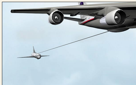
Технология взлета на буксире, разрабатываемая компанией Kelly Space & Technology Inc.
