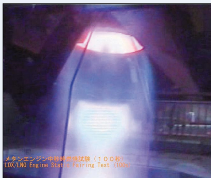
Огневые стендовые испытания камеры сгорания на метане (вверху) и тестовый бак для жидкого метана (внизу)
