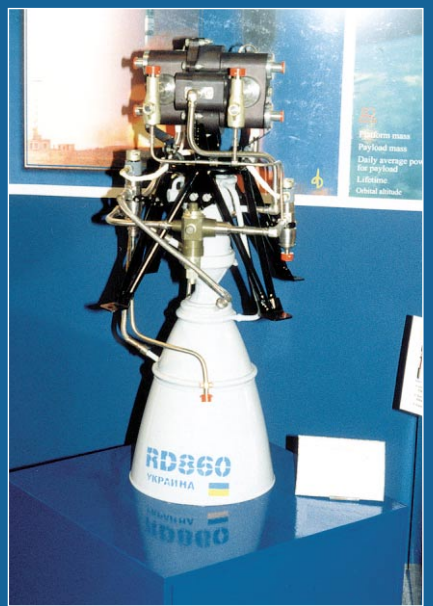
Маршевый двигатель третьей ступени перспективного варианта «Циклон-4» (слева) и рулевой двигатель второй ступени (справа), спроектированные и изготовленные в НПО «Южное» (Днепропетровск)
