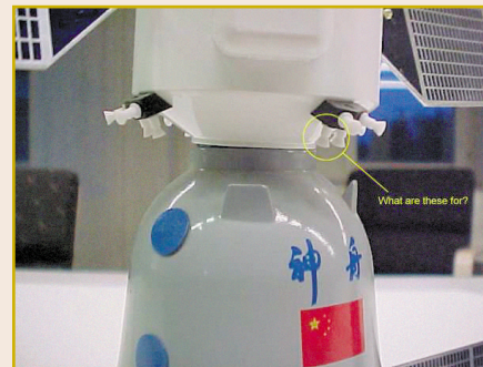
Что бы это значило? В таком положении микродвигатели ОМ будут «дуть» на спускаемый аппарат
