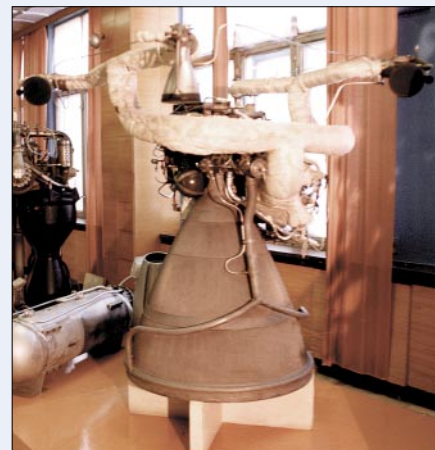
Двигатель 11D49, установленный на второй ступени РН «Космос-3М»
