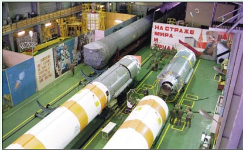
Сборка и испытание РН «Космос-3М в МИКе
