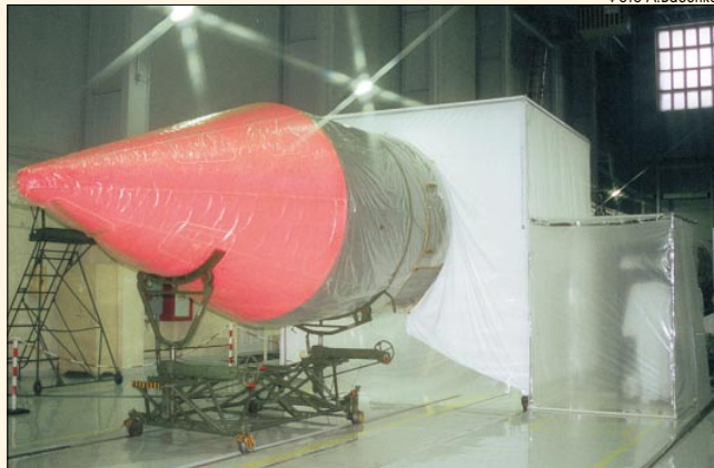
«Чистая» палатка, закрывающая космическую головную часть при работе с КА
