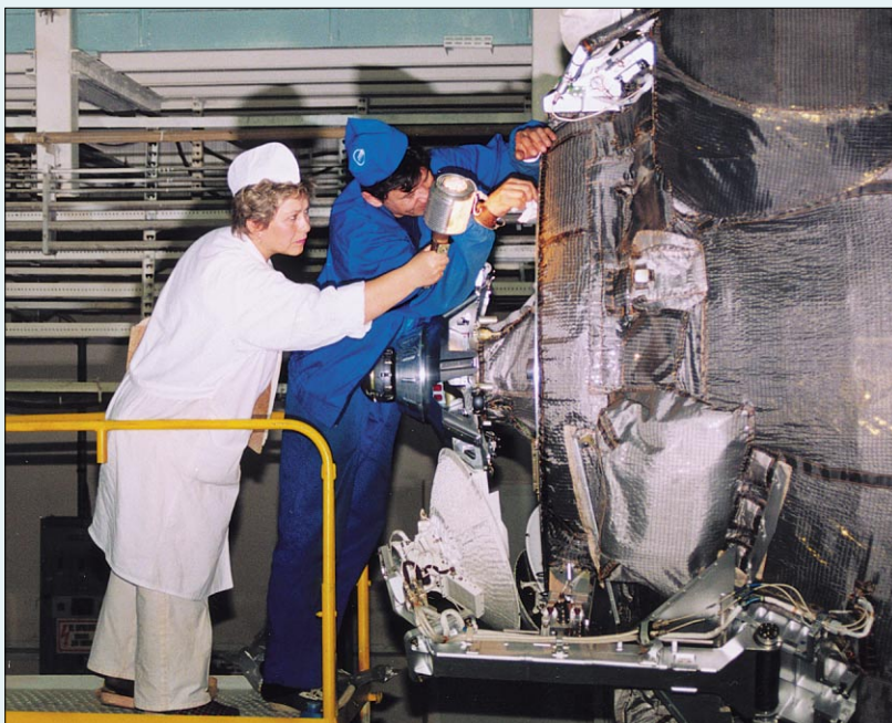
▲ Заключительный осмотр механизмов стыковочного узла
