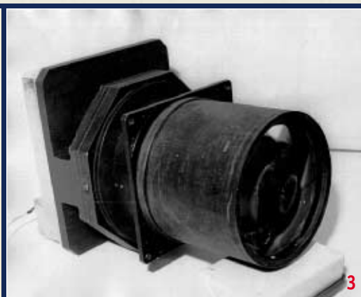
1 – датчик измерения координат центра Земли; 2 – прибор БОКС с рабочим полем 92°x48° и точностью 1'; 3 – оптико-электронная звездная камера с обнаружительной способностью до 12 м
