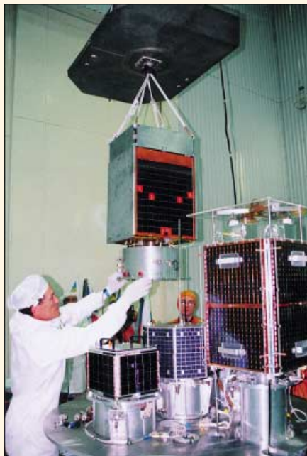
Спутники с адаптерами устанавливаются на опорную плиту
