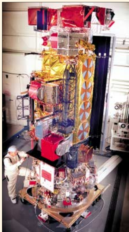
1 – платформа аппаратуры; 2 – инерциальный измерительный блок; 3 – разворачиваемый экран; 4 – AVHRR; 5 – жалюзи СТР (15 шт); 6 – приемная антенна системы SRSAT; 7 – всенаправленная антенна диапазона S (6 шт); 8 – аккумуляторы; 9 – двигатели ориентации; 10 – привод СБ; 11 – SBUV/2; 12 – AMSU A2; 13 – передающая антенна системы SRSAT; 14 – антенна ОВЧ-диапазона реального времени; 15 – антенна «Маяка»; 16 – AMSU B; 17 – антенна УВЧ-диапазона системы DCS; 18 – AMSU A1; 19 – антенна передатчика S-диапазона (4 шт); 20 – датчик Земли; 21 – HIRS.
