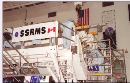
Манипулятор SSRMS устанавливается на платформу SLP
