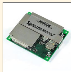
Спутниковый модем и устройство для отправки «глобалграмм»
