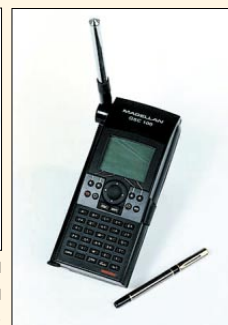
Спутниковый модем и устройство для отправки «глобалграмм»
