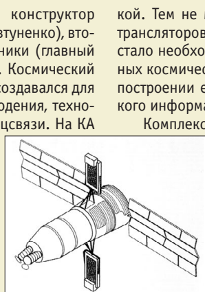
Проект КА «Ресурс-Спектр-В», созданный, судя по всему, на основе «Янтаря-4КС». Хорошо видны две антенны для передачи информации через КА «Гейзер» (Jane's Space Directory)
