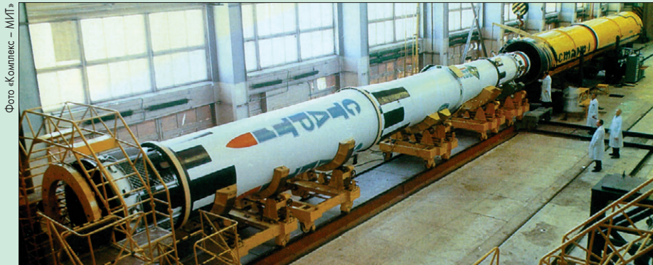
Загрузка в транспортно-пусковой контейнер РН «Старт-1», созданной на базе комплекса РС-12М «Тополь» (SS-25)
