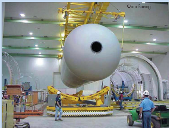
Подготовка к испытанию бака водорода первой ступени РН Delta 4 на заводе в Декатуре
