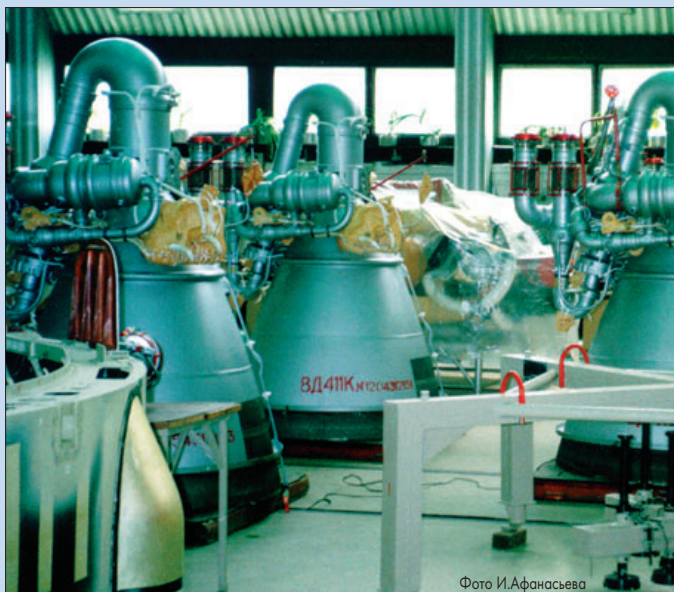
Модификации двигателя 8Д411К разработки КБ химической автоматики установлены на второй и третьей ступенях РКН «Протон-К»
