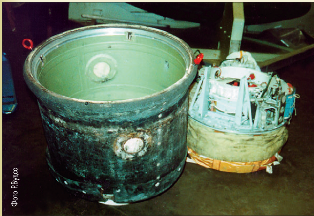
Парашютная система капсулы (справа) и ее теплозащитная оболочка (слева)
