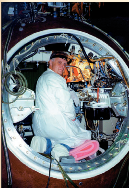
Монтаж оборудования внутри СА «Фотона-12»
