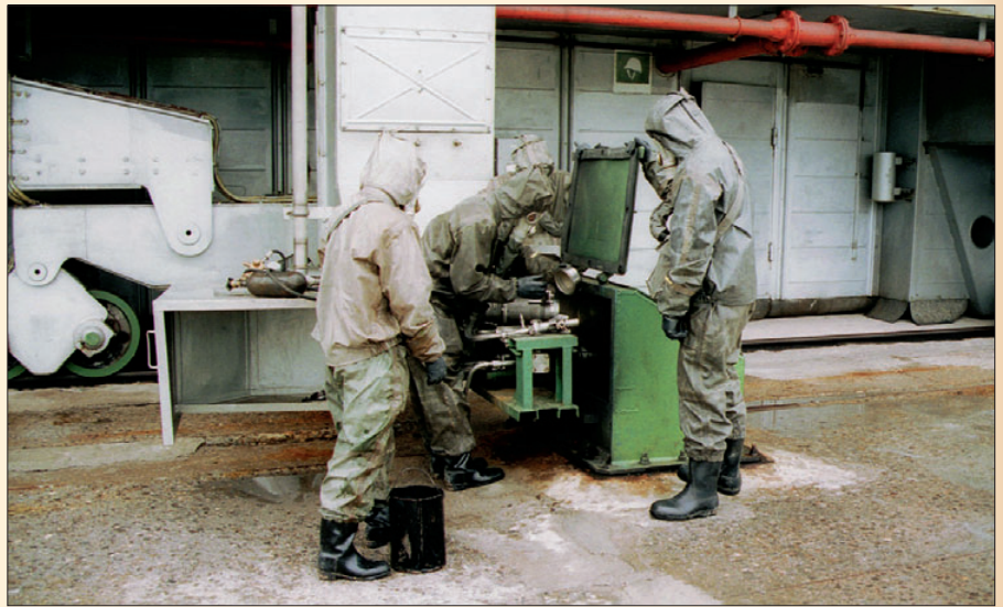
Стыковка заправочных коммуникаций на 1-й ступени РН «Космос-3М»
