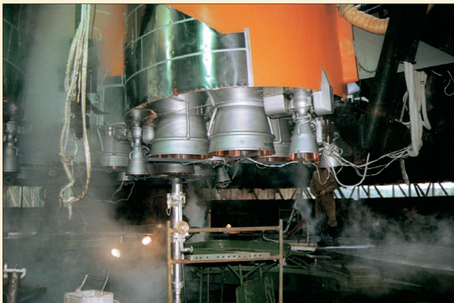
Этап подготовки ракеты – опускание площадок колонн обслуживания
