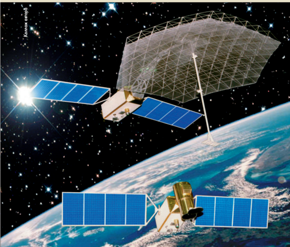
Радиолокационный (сверху) и оптический варианты КА «Кондор Э»
