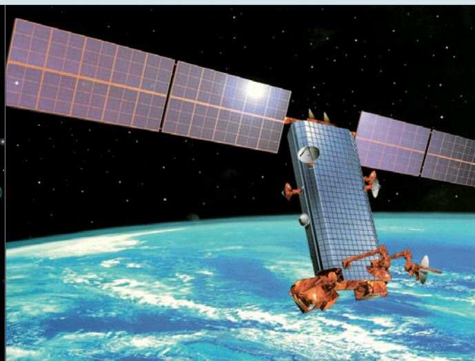
Аппараты системы Space-Based Infrared System: высокоорбитальные (SBIRS High) и низкоорбитальные (SBIRS Low)
