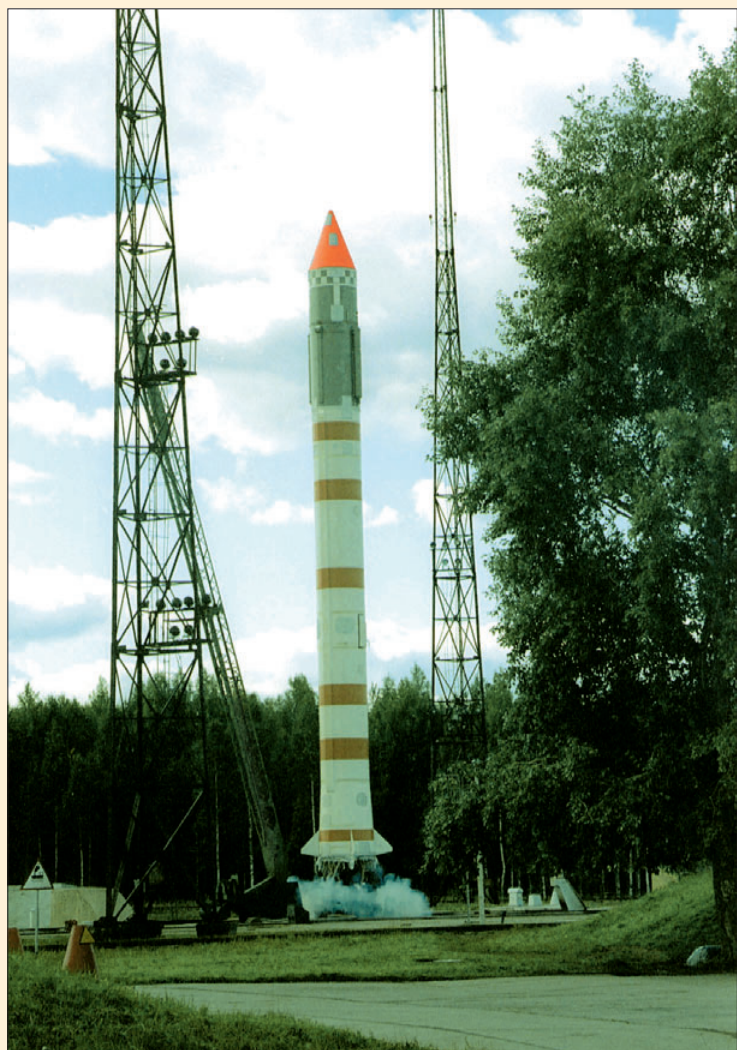
Уникальный кадр – прорыв мембран при запуске маршевых двигателей
