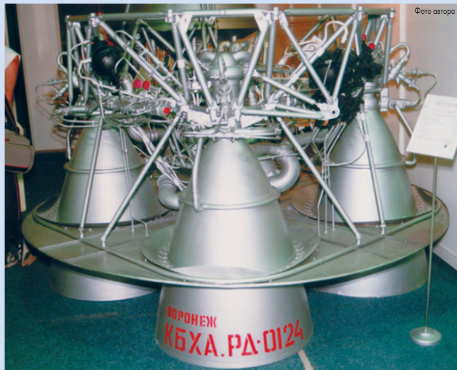
Двигатель РД-0124, который тоже может быть переведен с керосина на природный газ
