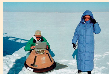
Модель спускаемой капсулы Stardust после испытательного сброса 5 февраля 1998 г. с аэростата с высоты 4 км на полигон в штате Юта
