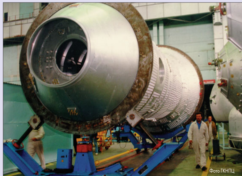
Таким был первый элемент МКС в 1996 году. Корпус ФГБ на монтажной тележке в цехе Центра Хруничева
