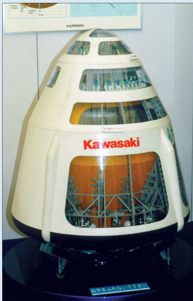
Слева – макет «туристического космического корабля» Kankoh-Maru; Справа – схема корабля Kankoh-Maru: 1 – кабина экипажа; 2 – пассажирский салон; 3 – бак жидкого водорода; 4 – бак жидкого кислорода; 5 – маршевый ЖРД; 6 – стартовый ЖРД; 7 – посадочная опора.
