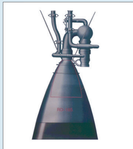
Кислородно-метановые двигатели РД-169 и РД-185 отличаются только соплом
