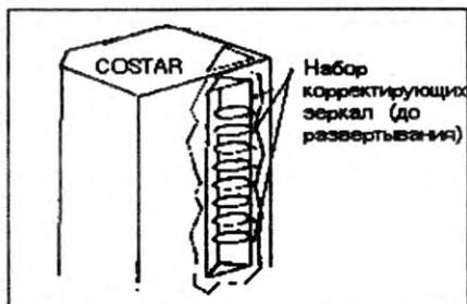
Рис. 2. Комплект корректирующей оптики COSTAR
