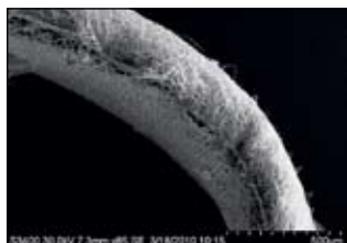
Стенка сосудистого графта из поликапролактона состоит из тончайших волокон, переплетённых между собой. Изображение сканирующей электронной микроскопии. Фото Вадима Борисова.
