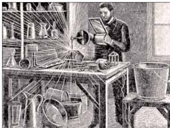
Паяние с помощью электрической (вольтовой) дуги
