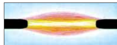
«Дуга Петрова» — электрический разряд в воздухе между угольными электродами
