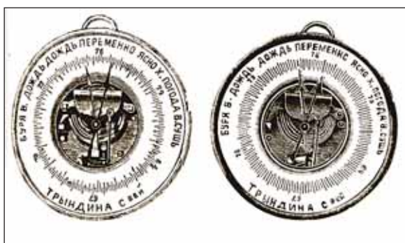
Барометр-анероид – прибор для измерения атмосферного давления
