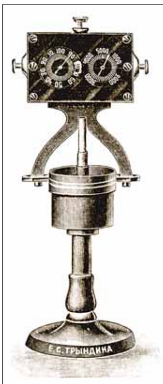
Сирена Коньяр-Латура – прибор для изучения звуковых колебаний в газовой среде
