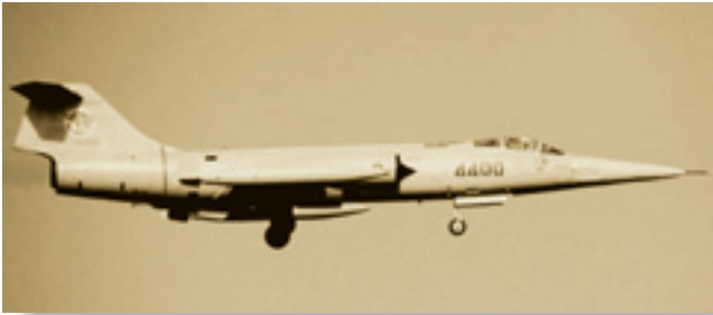
Самолет-разведчик RF-104G-Eu оборудованный системой LOROP для фотографирования военных объектов в Китае
