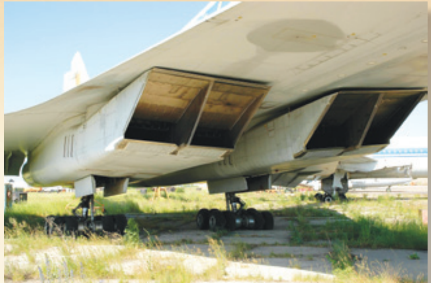
Сверхзвуковой пассажирский самолет Ту-144. Вид на воздухозаборники и мотогондолы двигателей
