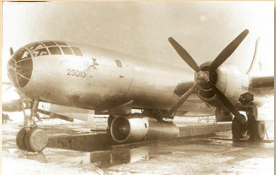
Летающая лаборатория Ту-4ЛЛ для испытаний двигателей АМ-3
