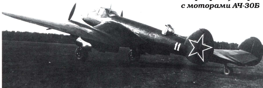
Бомбардировщик Ер-2 с моторами АЧ-30Б
