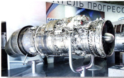
«Изделие 117С» - ТРД с управляемым вектором тяги поколения 4+, создается НПО «Сатурн» совместно с УМПО по заказу ОКБ Сухого для экспортного истребителя Су-35
