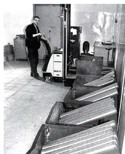
Рис. 5 Мерные шихтовые заготовки, подготовленные к отправке на моторостроительные заводы.
