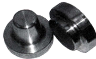
Обточенные штамповки дисков из сплава ЭИ698-ВД. Заказчик ОАО «КАДВИ»
