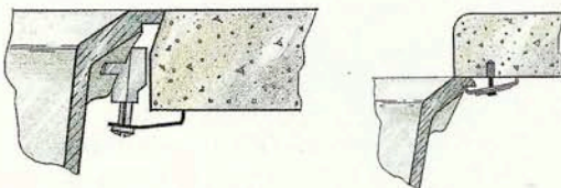
⊕ Для установки композитных моек заподлицо и под столешницу делаются бортики разной конфигурации
