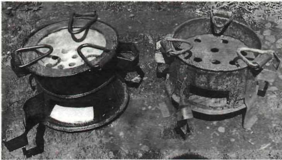
В Кении предпочитают использовать в качестве топлива древесный уголь. Усовершенствованная модель (слева) традиционной печи «джики» позволяет средней семье в Найроби почти вдвое снизить расходы на топливо.
