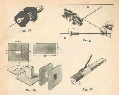
картона (рис. 26). Гильзы катушек склейте на деревянной планочке такой же толщины, как и полюса статора (рис. 27). Собранные катушки промажьте столярным клеем, они станут значительно прочнее.
