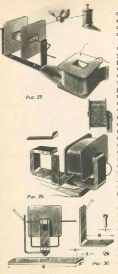
Подшипник крепится к статору при помощи одного болтика с гайкой от «Конструктора» (рис. 30).
