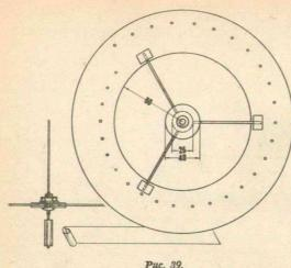
иголку сквозь отверстия. При тщательной разметке пробивке самодельный диск дает неплохое изображение.
