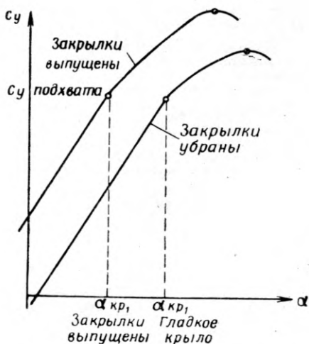
Изменение критического угла атаки при выпущенных закрылках.
