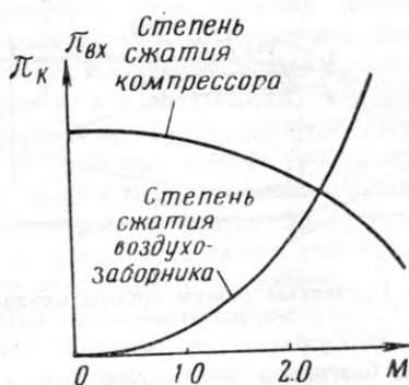
Рис. 1. Зависимость степени сжатия компрессора и воздухозаборника от числа M полета.
