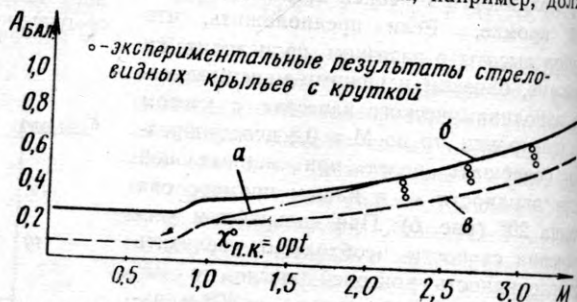
Рис. 7. Сравнение коэффициента отвала балансирующей поляр A_{\text{Бал}} треугольного крыла с круткой стреловидного крыла изменяемой стреловидности с круткой и без крутки по числам M полета: а — крыло изменяемой стреловидности без крутки; б — треугольное крыло без крутки; в — стреловидное крыло изменяемой геометрии с круткой. Точками показаны результаты экспериментов для стреловидных крыльев с круткой.
