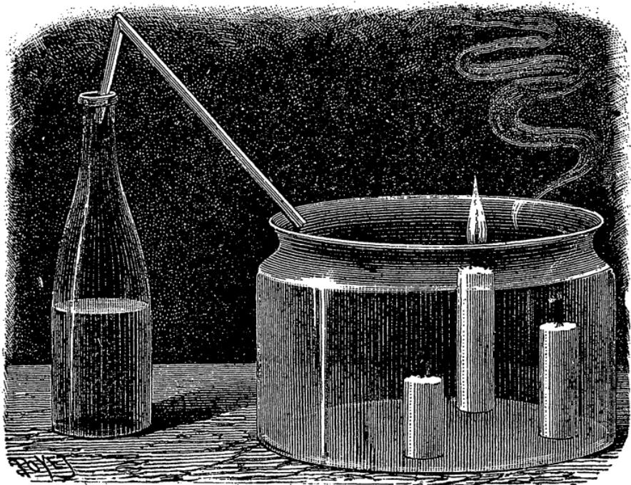
свечей. Удалим воздух из трубки, и углекислый газ начнет незаметно для нас (т. к. он прозрачный) перетекать в банку. Скапливаясь в банке, углекислый газ сначала добирается до пламени самой маленькой свечки. Пламя бледнеет и гаснет. Затем гаснут вторая и третья свечи.
