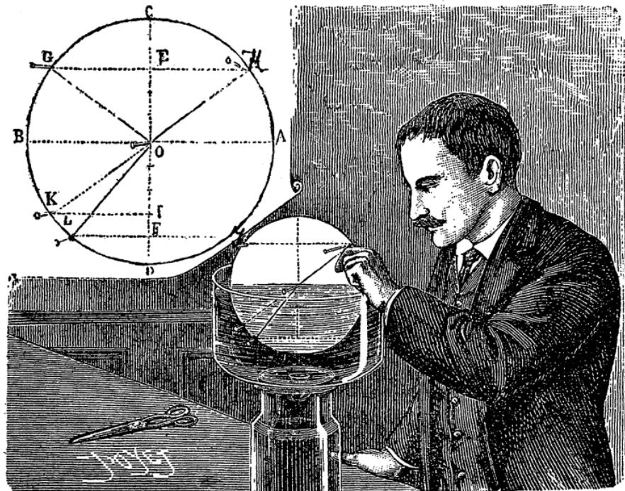
Держите кружок вертикально в миске или ведре с водой таким образом, чтобы горизонтальный отрезок ВА совпал с уровнем воды. (Для зрителей возьмите прозрачную емкость.)
