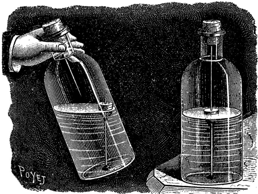
ли банка стоит на ровной горизонтальной поверхности, обе булавки своими острыми концами приходились как раз одна против другой. Когда это достигнуто, закрепите осторожно верхнюю пробку воском или парафином в горлышке банки, и прибор готов.
