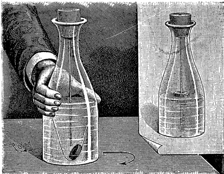
на стол). Под действием центробежной силы в воде образуется большая воронка, которая дойдет почти до дна бутылки. Пробка опустится вместе с водой, а затем, соскользнув со спицы, всплынет наверх.
