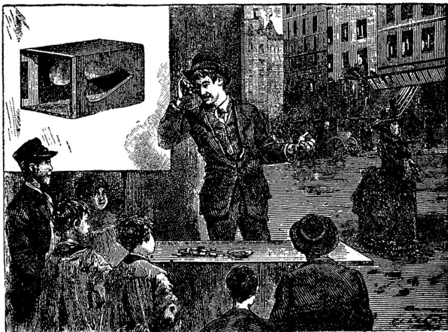
Если вы прельститесь словами торговца и приобретете чудесный прибор, то получите маленькую картонную коробочку, открытую с одного конца и сбоку. Внутри коробочки вставлен кусочек зеркала наклонно к ее диагонали, под углом  $45^\circ$ . Весь прибор очень прост, и вы сами легко можете его построить (см. рисунок в левом верхнем углу). Коробочку можно взять хотя бы из-под спичек.
