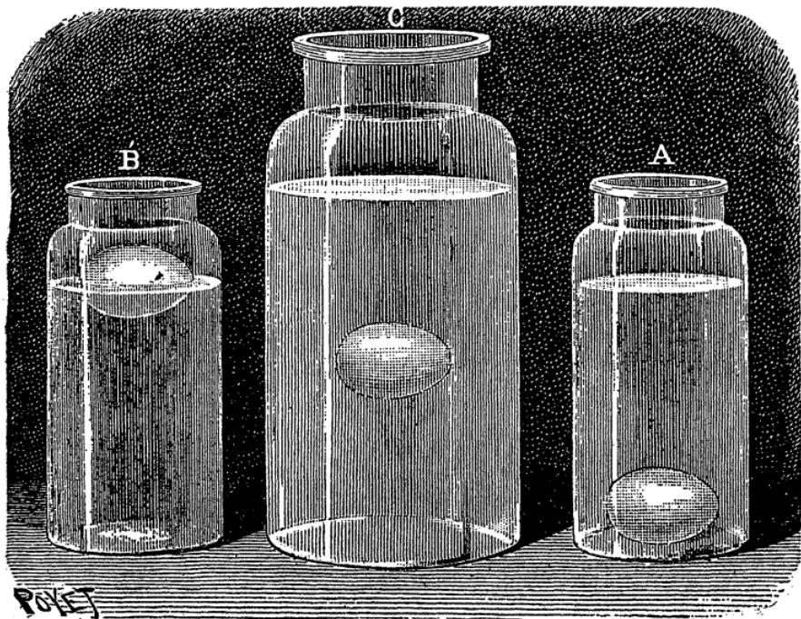
Возьмем две небольшие банки А и В и третью вдвое большую С. Наполним банку А чистой водой и опустим в нее свежее яйцо. Яйцо сейчас же опустится на дно, так как его удельный вес больше удельного веса пресной воды. Яйцо, опущенное в насыщенную солью воду сосуда В, будет плавать на ее поверхности, так как его удельный вес теперь меньше удельного веса соленой воды.
