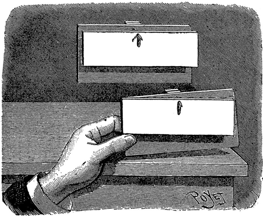
дут параллельны один другому; если же доска стола наклонна, то меньший картон будет висеть по-прежнему горизонтально, а больший картон, поставленный на плоскость, будет стоять уже наклонно и поэтому составит с меньшим картоном какой-нибудь угол.
