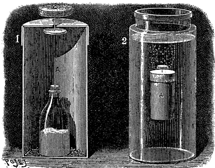
не образуется большое количество углекислого газа. Газ вытесняет воду из цилиндра и поднимает его на поверхность. При этом давление газа прижимает картонный кружок к крышке. Однако, как только крышка достигнет поверхности воды, пробковый кружок, больше не поддерживаемый водой, в силу своей тяжести опускается и открывает отверстие крышки, через которое газы поднимаются в воздух. Вода опять наполняет цилиндр, и он снова опускается, и так несколько раз.
