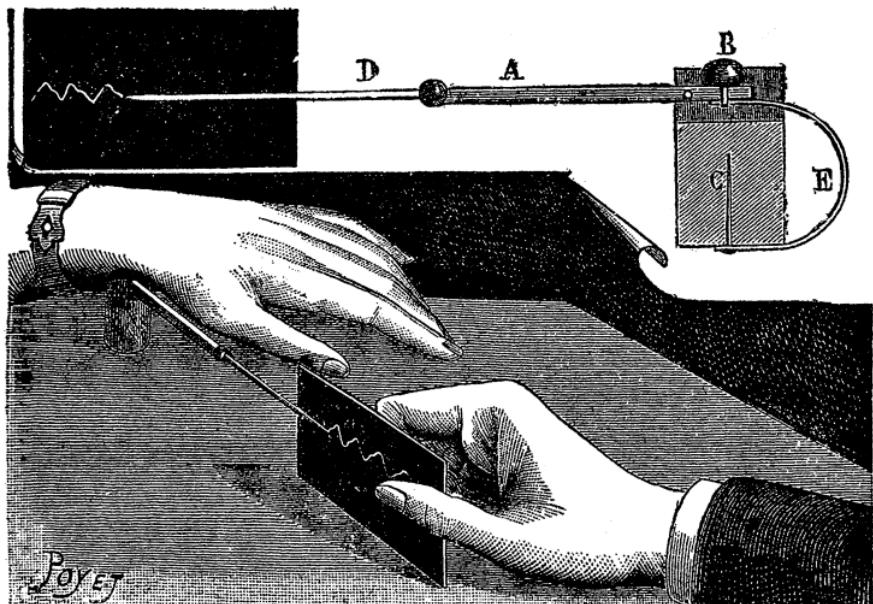
чик этой полоски. Из того же гусиного пера вырежьте другую полоску Е, немножко шире полоски D, прикрепите ее булавкой к основанию пробки, загните полукругом и вденьте ее в ушко пуговки, под коротким концом рычага спички. Эта полоска будет служить пружиной, на которой сидит спичка с пуговицей. Пуговица должна слегка выступать из пробки.
