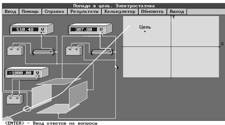
Рис. 3.3. Иллюстрация работы электронной пушки
