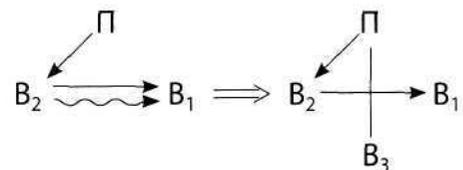
Вещество  $B_3$  может быть введено в систему извне в готовом виде или получено (действием  $\Pi_1$  или  $\Pi_2$ ) из имеющихся веществ. В частности,  $B_3$  может быть «пустотой», пузырьками, пеной и т.д.
