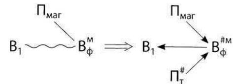
Если веществу, входящему в феполь (или могущему войти в феполь), должна быть придана определенная пространственная структура, то процесс следует вести в поле, со структурой, соответствующей требуемой структуре вещества:
