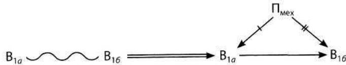
Введение нового поля, как отмечалось, вынужденное отступление от идеала. Поэтому используем уже имеющееся в системе механическое поле: если закрутить поток, центробежные силы стонят пузырьки к оси трубопровода, откуда их нетрудно убрать.
