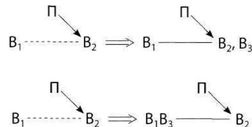
Предположим, в условиях задачи на обнаружение неплотностей в агрегате холодильника имеется ограничение: люминофор нельзя вводить в жидкость. В этом случае вещество-обнаружитель может быть расположено на наружной поверхности агрегата (а. с. № 311109). Возникает внешний комплексный веполь.
