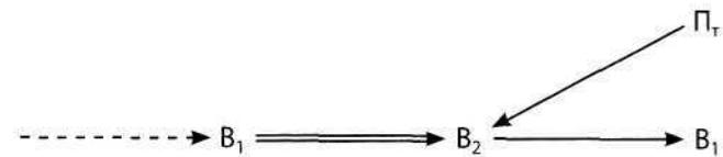
Дано плохо управляемое вещество — изделие  $V_1$ . Чтобы обеспечить хорошую управляемость, надо перейти к системе, в которой тепловое поле  $\Pi_r$  действует на вещество — инструмент  $V_2$ , связанное с  $V_1$ . Структуры из  $\Pi_r$ ,  $V_2$  и  $V_1$  получили название **теполей**.
