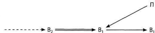
Такую структуру принято называть **веполь** (от слов «вещество» и «поле»). Нетрудно заметить, что **веполь является схемой минимальной ТС**: он включает изделие, инструмент и энергию (поле), необходимую для воздействия инструмента на изделие. Любую сложную техническую систему можно свести к сумме веполей. Тут уместна аналогия с геометрией: любую сложную фигуру можно разбить на треугольники. Зная свойства треугольников, можно производить вычисления, связанные со сложными
