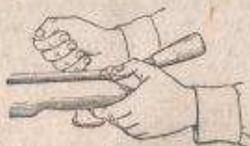
Рис. 170. Как отделить тыльную крышку
