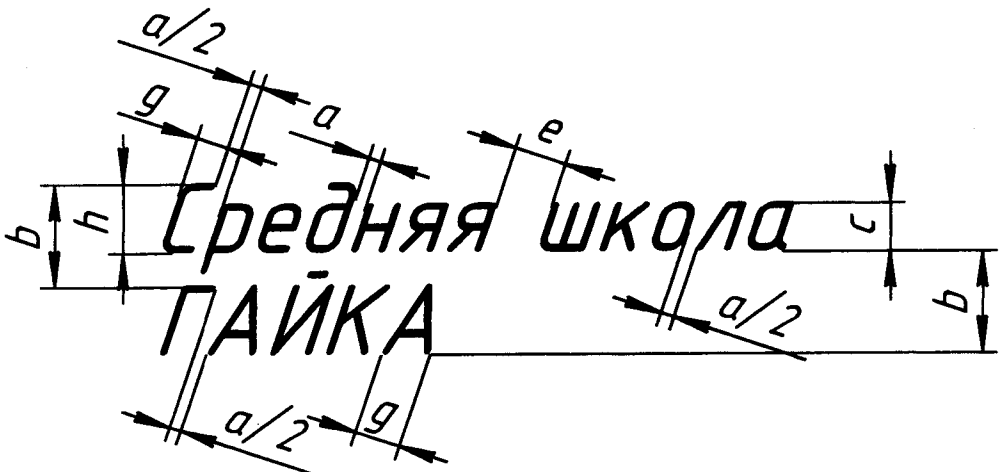
Рис. 40. Размеры, используемые при выполнении надписей чертежным шрифтом
